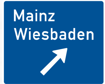
332-20 Ausfahrt von der Autobahn
